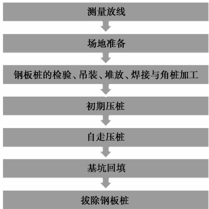
图4 钢板桩施工流程图
