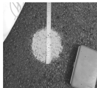
图6 试验段构造深度检测
