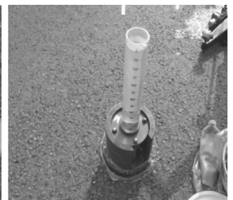
图7 试验段渗水系数检测
