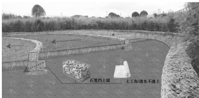
图3 石笼挡墙示意图
